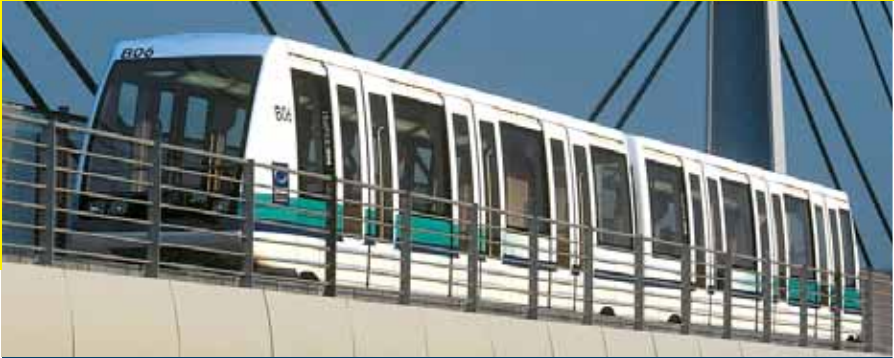
Val (Véhicule Automatique Léger) – vollautomatisches fahrerloses Stadtbahnssystem
